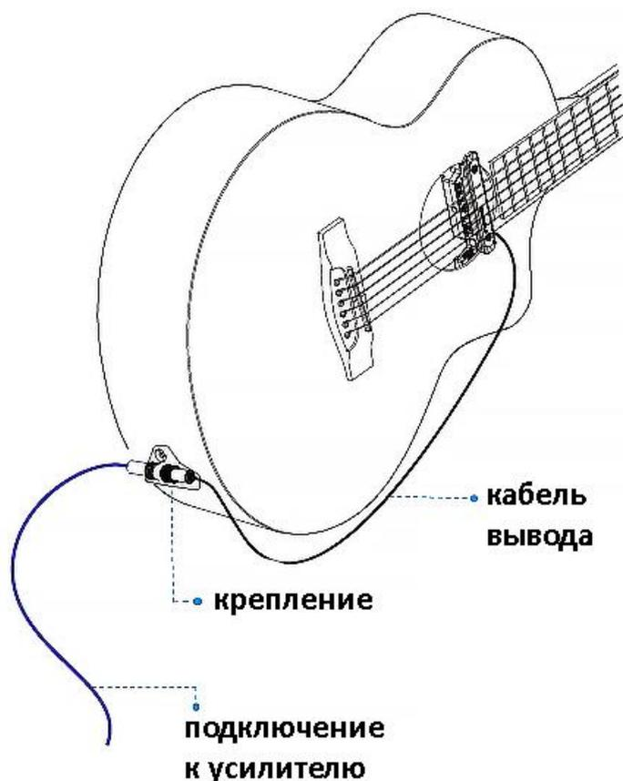
Если вы путешествуете с гитарой или долго храните ее с установленным звукоснимателем, мы настоятельно рекомендуем установить коннектор внизу грифа навсегда. Установите коннектор выводного кабеля в гитару, следуя инструкциям по установке.
