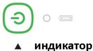
Многофункциональный индикатор с различными цветами подсветки. Когда индикатор приемника становится зеленым, это означает, что беспроводное соединение успешно сопряжено. Если индикатор приемника желтый, сопряжение не удалось.
