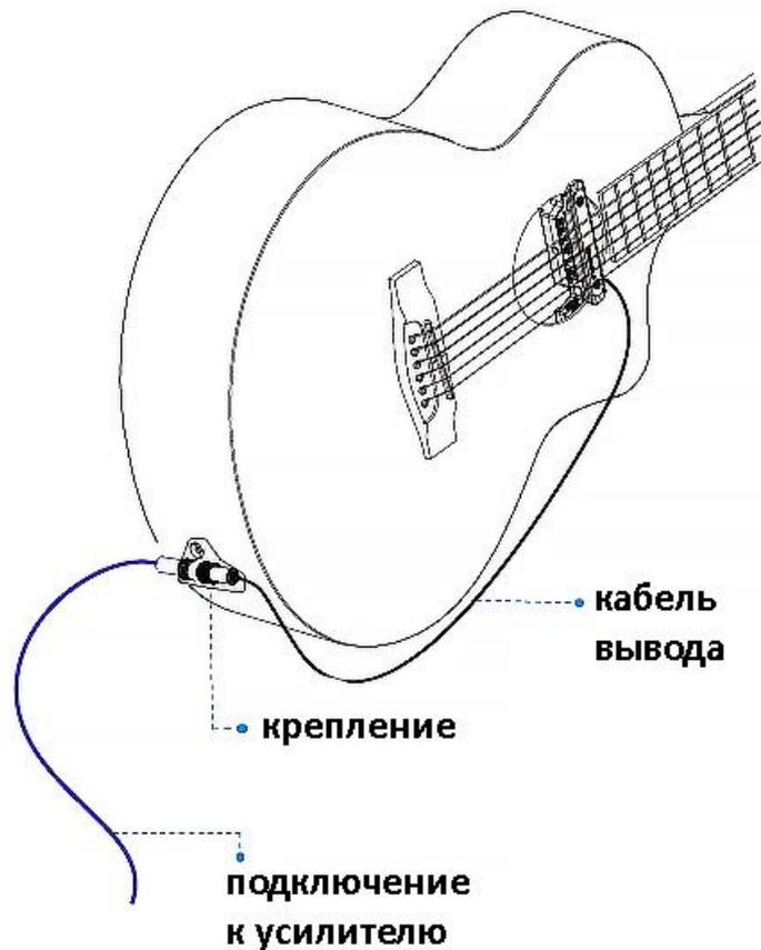
Если вы путешествуете с гитарой или долгое время храните ее с установленным звукоснимателем, настоятельно рекомендуем установить джек постоянно в гитару. Пожалуйста, установите концевой джек выходного кабеля на вашу гитару, следуя инструкциям по установке.
