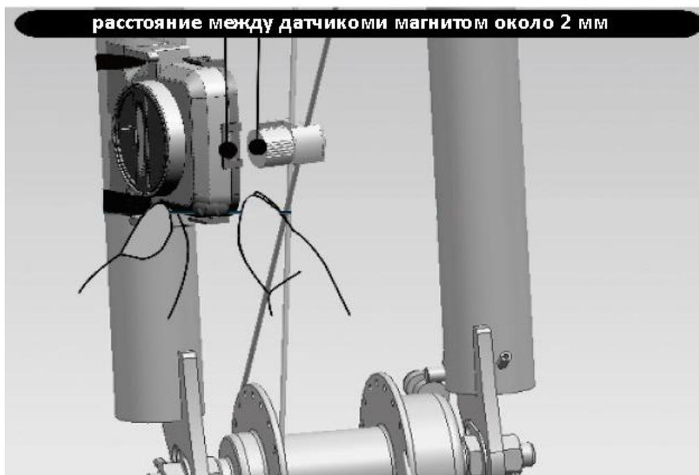
Этот шаг очень важен. После установки датчика и магнита необходимо придвинуть датчик к магниту так, чтобы расстояние между датчиком и магнитом составляло около 2 ММ. Чем меньше расстояние, тем стабильнее передача скорости. Как показано на рисунке выше
