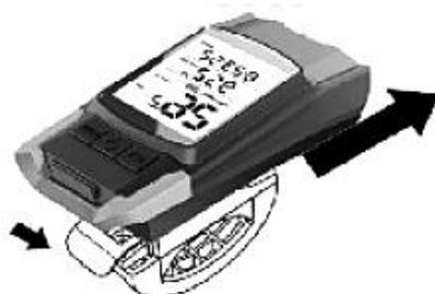
Сначала нажмите на зажим и потяните основной блок вперед, чтобы снять его.
