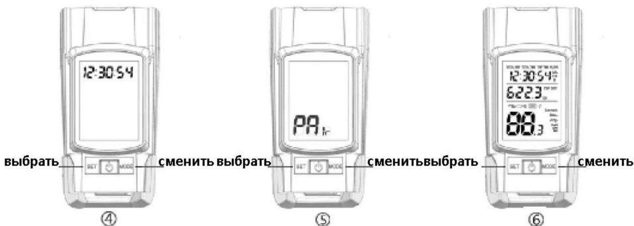
4. Настройка часов: нажмите клавишу Set, чтобы установить значение часов. Нажмите клавишу режим (MODE), чтобы переключиться на следующее значение.
