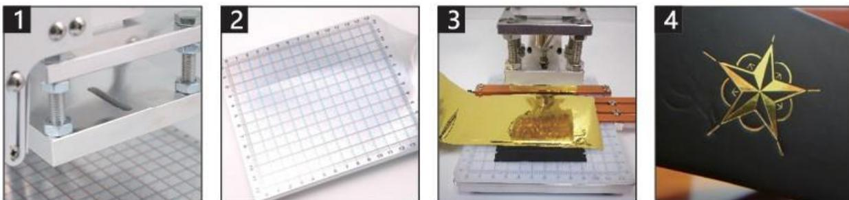
U-образная нагревательная пластина, удобная установка медной формы, основание со шкалой, простота в эксплуатации, высокая производительность, подходит для горячего тиснения небольшого логотипа.
