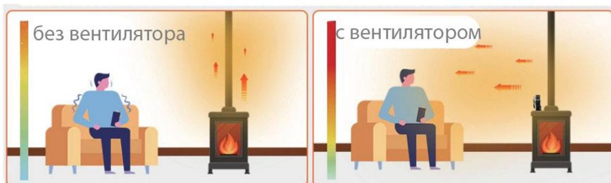
Установите вентилятор на гладкую ровную поверхность верхней части печи, ближе к боковой или задней стороне. Чем горячее поверхность печи, тем больше теплого воздуха распределяет вентилятор.
