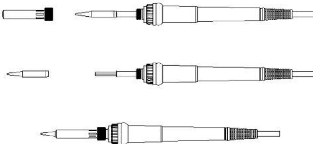
Примечание: Если паяльник не нагревается после замены нагревательного элемента, нагревательный элемент можно вставить обратно и отключить. Проверьте, правильно ли он установлен;
