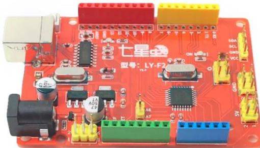
Контроллер / плата / микропроцессор Arduino UNO R3 считывает показания датчиков, управляет исполнительными механизмами (актуаторами) и выводит результат для пользователей.
