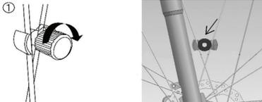
Закрепите датчик пластиковым ремешком, при этом магнит должен быть на середине датчика.
