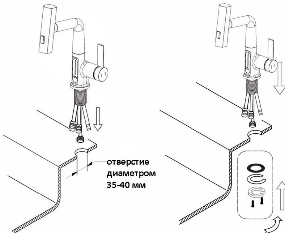
3. Рукой завинтите контргайку, затем с помощью крестовой отвертки закрутите крестообразный винт на контргайку, чтобы усилить надежность.
