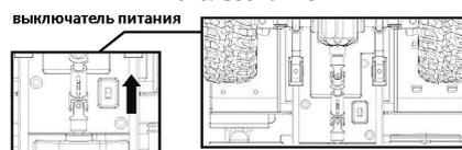
Включите питание радиоуправляемой машинки и поместите её на плоскую поверхность. Затем включите питание джойстика. Когда индикатор джойстика перестанет мигать, вы можете управлять машинкой с помощью вашего джойстика.
