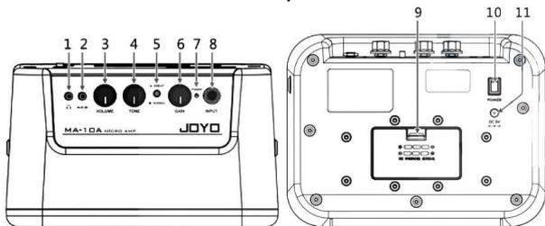
1. Разъем наушников: это 3,5-мм выходной стереофонический разъем, динамик отключается автоматически при подключении к наушникам.
