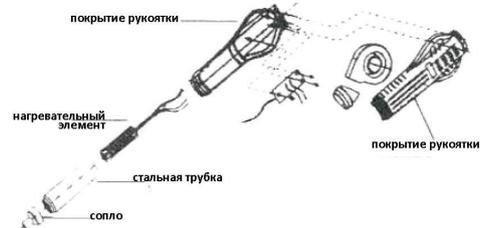
Если паяльник не нагревается после замены нагревательного элемента, нагревательный элемент можно вставить обратно и отключить. Проверьте, правильно ли он установлен;
