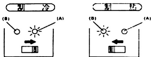
Когда выключатель автомобильного холодильника установлен в положение «выключено», вставьте один конец провода в выходное отверстие холодильника, а другой конец в прикуриватель автомобиля. Для включения охлаждения установите переключатель в положение COLD. Зеленый свет индикатора указывает на включение функции охлаждения. Для включения нагрева: установите переключатель в положение HOT. Загорится красный свет индикатора, и поверхность начнет нагреваться.
