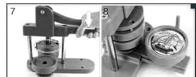
[5.6.7] Положите прокладку на нижнюю часть железного значка. Пластиковая нижняя часть значка не требует прокладки. Положите пластиковую прокладку в правую форму, затем положите часть значка с булавкой, стороной с булавкой вверх. Сдвиньте правую форму, чтобы она оказалась под верхней формой, нажмите на ручку; верхняя форма должна быть закрыта, как показано.
