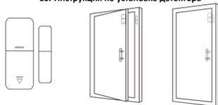
1. Зазор между магнитом и датчиком должен быть менее 10 мм.;
