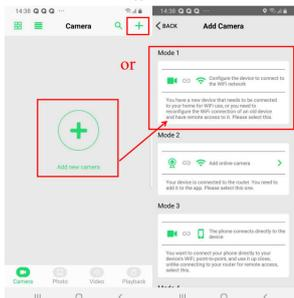
Нажмите «Перейти к конфигурации WiFi», чтобы подключиться к сети, которая совпадает с UID камеры (уникальным для каждого устройства). Если точка доступа WiFi отсутствует, перезагрузите камеру.
