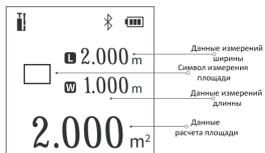
**Измерение объема:** нажмите клавишу «Вкл./Измерение» и измерьте длину и ширину по очереди. Пунктирная линия во время измерения указывает край, который необходимо измерить. Когда все стороны измерения указывает край, который нужно измерить. Когда все стороны измерены, система автоматически вычислит площадь.
