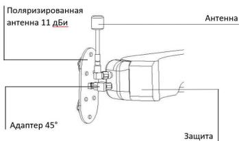
При использовании антенны рекомендуется использовать рабочую частоту 5650-5700 МГц.
