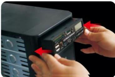
Вставьте устройство в отсек 5.25;
