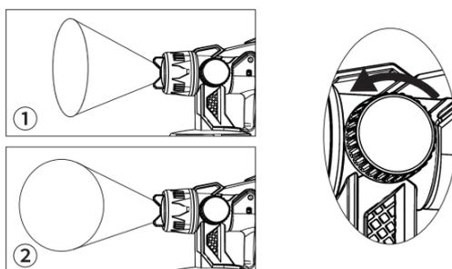
8) Регулировка типа распыления.
