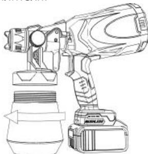
Отрегулируйте всасывающую трубку.
